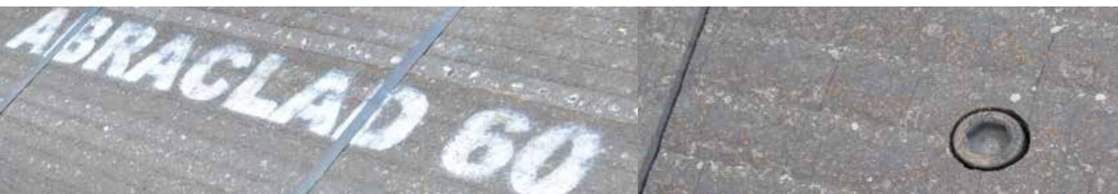
ABRACLAD 60 SB ist ein Verbundblech mit einer geraden Wulst-Schweißschicht. Aufgrund der relativ dünnen Hartschicht und einer gut ausgerichteten Struktur eignen sich diese Bleche hervorragend zum Kaltumformen zu Rohren, Kegeln, Schaufeln und anderen Werkstücken mit kritischer oder komplexer Form.
